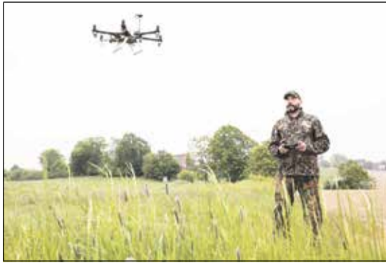
Die modernen Drohnen zur Kitzsuche sind mit einer Wärmebildkamera versehen und benötigen einen erfahrenen Piloten. Foto: Czybik/DJV
