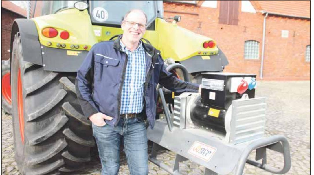
Tim Friedrichs hat für den Ernstfall vorgesorgt und ein Notstromaggregat angeschafft, das über eine Zapfwelle betrieben wird (Bild links).
